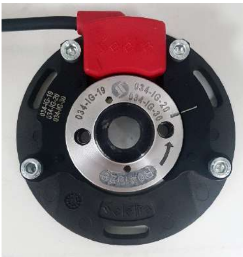
Photo de l'ensemble rotor, stator, bobine, boîtier électronique et câblage complet / Photo of the rotor, stator, coil, ECU unit and wiring loom
